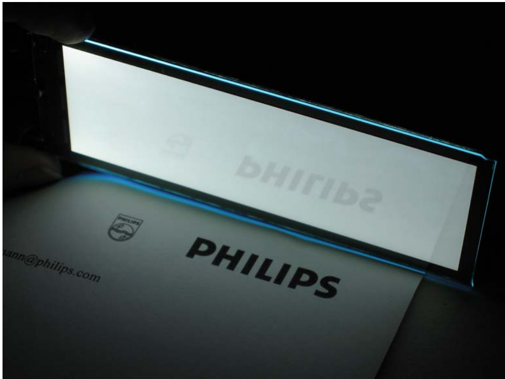
Beleuchtungsmodul basierend auf kleinen Molekülen (SM-OLED), Maße: 4x12cm 2 (Foto: Philips Lighting)
