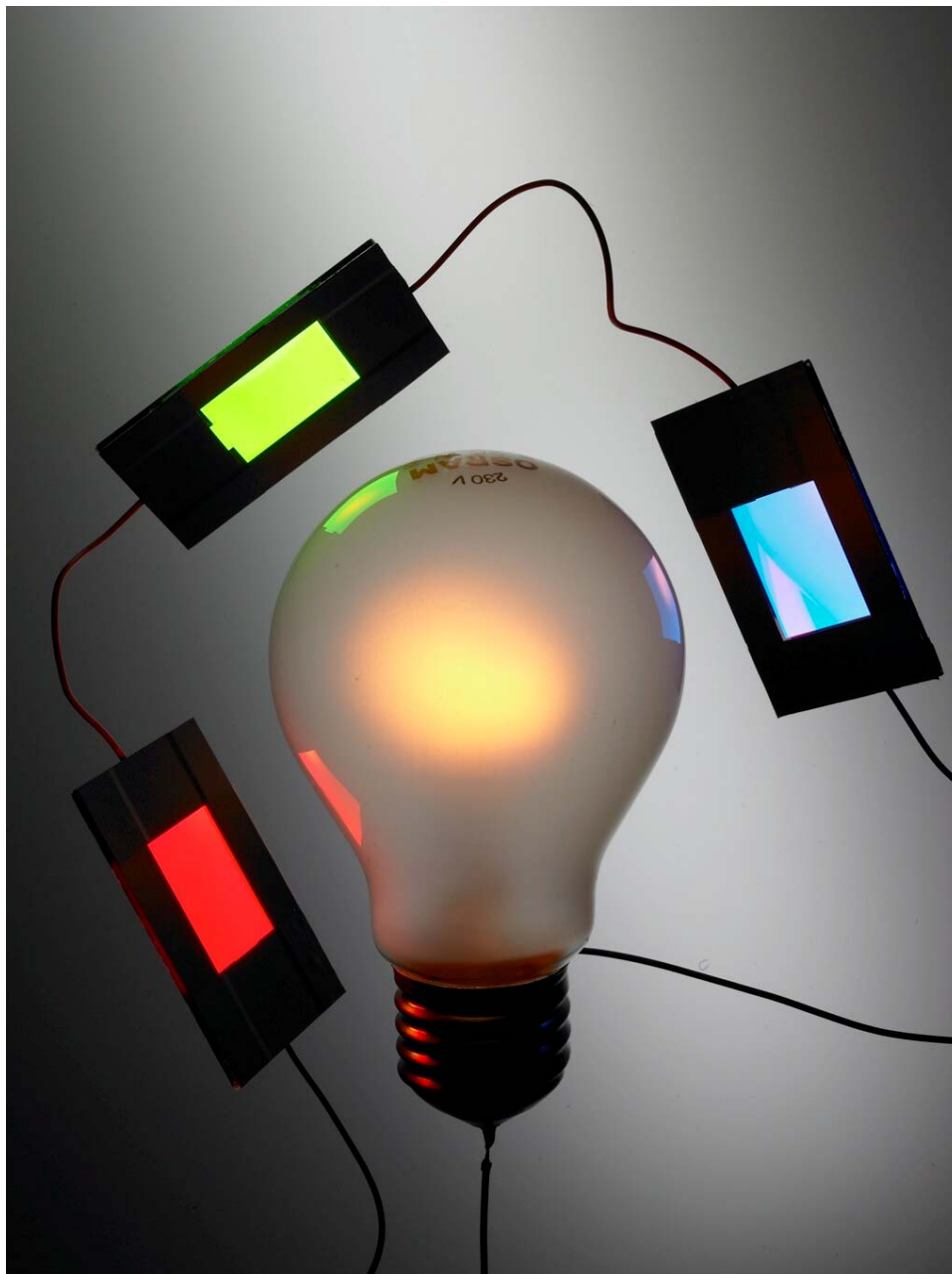
Légende : OLED colorées à petites molécules dotées de la technologie Novaled PIN OLED™ pour un rendement supérieur et une durée de vie prolongée. (Source photographique : Novaled)
